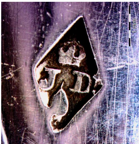
Figura 21. Marca de l'orfebre segellada a la plata. Fotografia feta des de la lupa d'augment.
