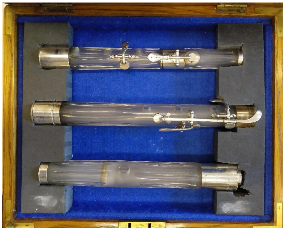
Figura 14. Flauta de vidre original desmuntada en tres parts, les dues primeres unides (peu i cos 2), al mig el cos 1, i la part inferior el cap. Fotografia feta al departament de química analítica de la UB.
