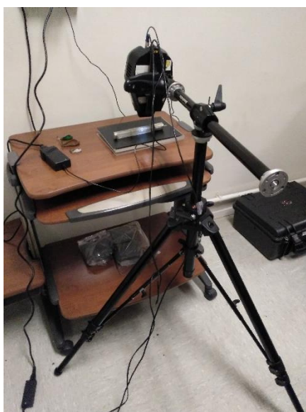
Figures 29 i 30. Aparell de XRF. A la primera fotografia a vista completa, amb el trípode. A la segona només el cap per on es dispara el feix de llum.
