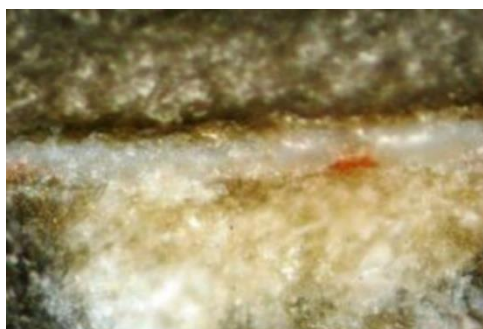
Figura 8. Estratigrafia d'una mostra del retaule de Montagut al microscopi òptic per reflexió. Imatge del TFM de Patricia Giménez.
