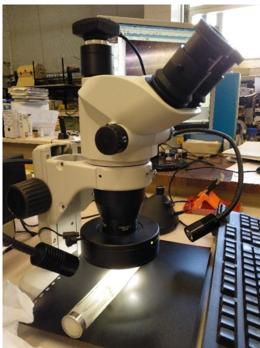
Figura 19. Lupa d'augment en el moment d'observar el cap de la flauta. Al fons es pot veure la pantalla a la qual anava connectada.
