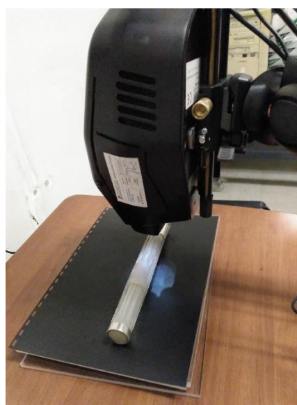
Figures 29 i 30. Aparell de XRF. A la primera fotografia a vista completa, amb el trípode. A la segona només el cap per on es dispara el feix de llum.
