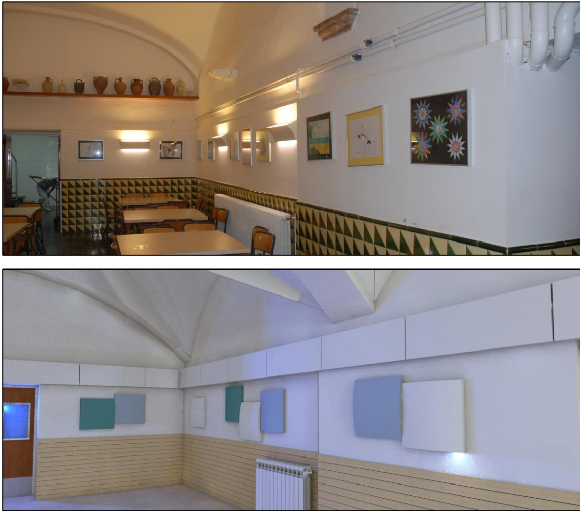
Figura 33. Proposta de millora. Panells fonoabsorbents de les parets.
