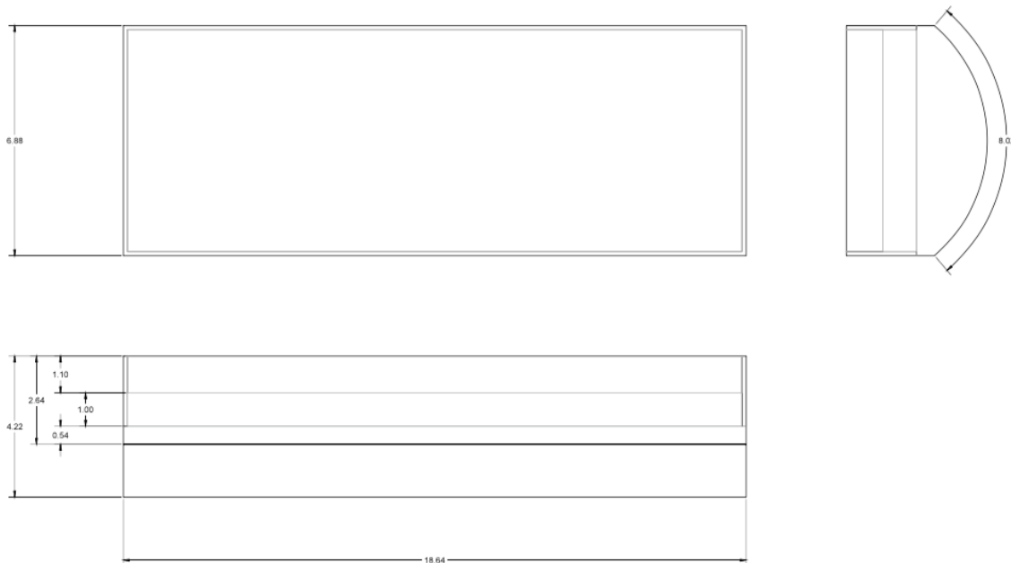
Figura 28. Plànol acotat de la simplificació de la sala.
