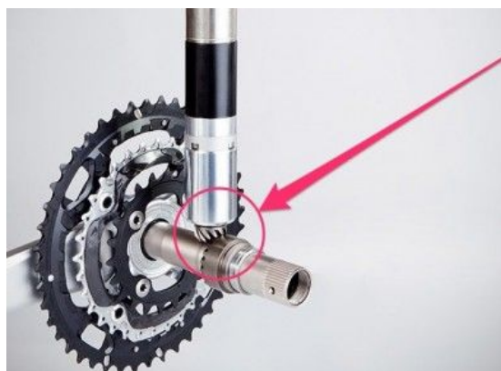
Imatge 29 i 30. Motors ocults en el quadre d'una bicicleta.
